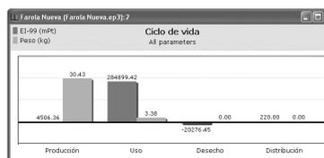
FIGURA 3. Diagrama de barras con el impacto ambiental y el peso en las diferentes etapas del Ciclo de Vida.
